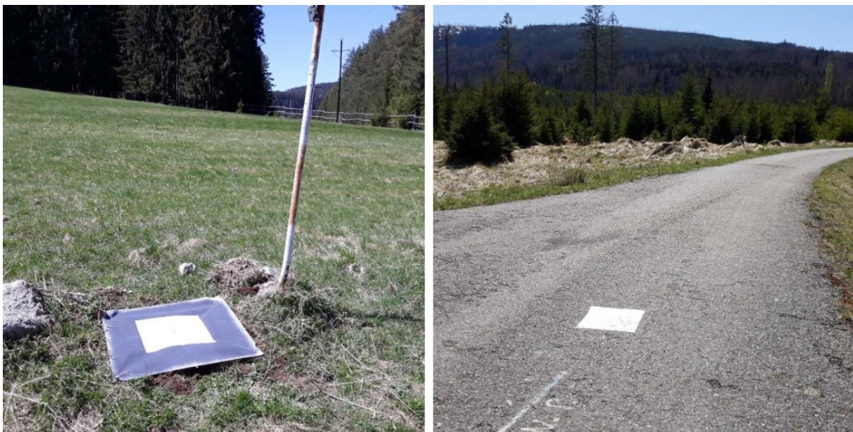
Obr. 6: Ukázka signalizace vlíčovacích bodů v roce 2021 a 2022
